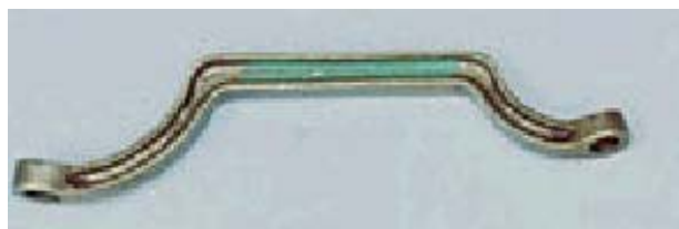
Figura 6.23. Chave de mangote.
