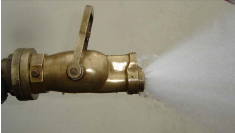
Fig. 5.29 Esguicho Universal produzindo jato tipo chuveiro através do crivo. Note-se a alavanca na posição para frente. Foto dos autores.
