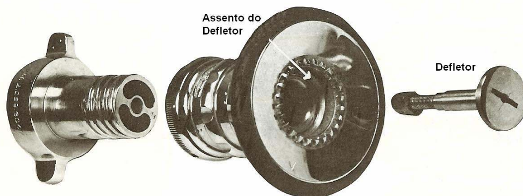
Fig. 5.17 - Outro tipo de esguicho regulável de vazão variável de controle rotativo com defletor e assento do defletor. Fonte: IFSTA – International Fire Service Training Association – Fire Stream Practices.
