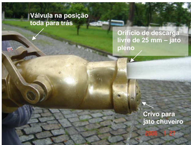
Fig. 5.28 Esguicho Universal modelo Rockwood, com introdução de DN 63 mm, orifício de descarga livre DN 25 mm e crivo com DN 38 mm, na posição alavanca toda para trás, que forma jato pleno. Foto dos autores
