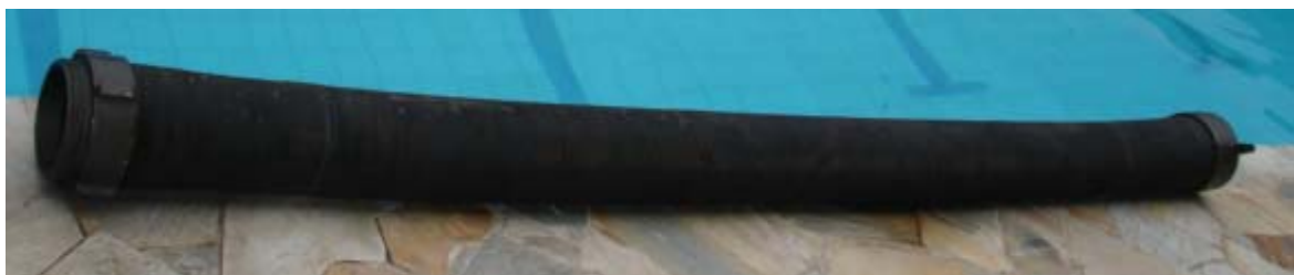
Fig. 4.5 - Mangote de 150 mm (6") feito em borracha com alma reforçada de arames metálicos.
