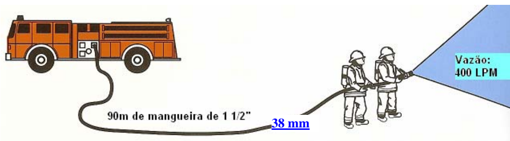
Fig. 7.6 - Exemplo de montagem de linha direta com 90 metros de mangueira (6 lances x 15 m cada lance) com diâmetro 38 mm e vazão no esguicho de 400 lpm.
