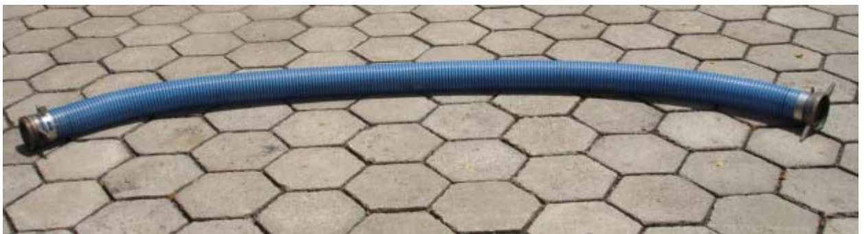
Fig. 4.2 - Mangote de 115 mm (4½”) feito em spiraflex transparente.
