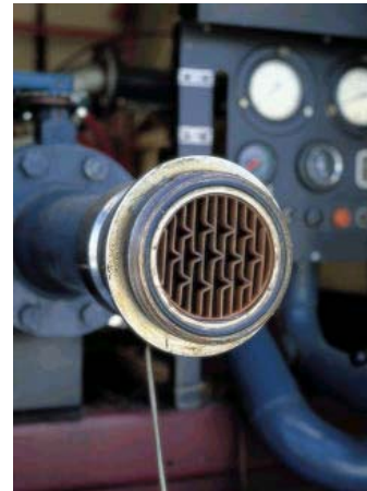
Figura 6.14. Anel de expansão de cobre para empatação interna da mangueira à junta de união
