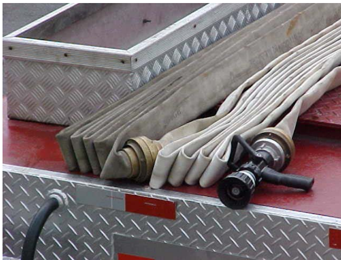
Figura 7.13. Exemplo de linha pré-conectada em ziguezague em pé no convés da viatura Foto dos autores
