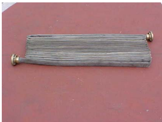
Figura 2.7: Acondicionamento de mangueira em ziguezague em pé Foto dos autores
