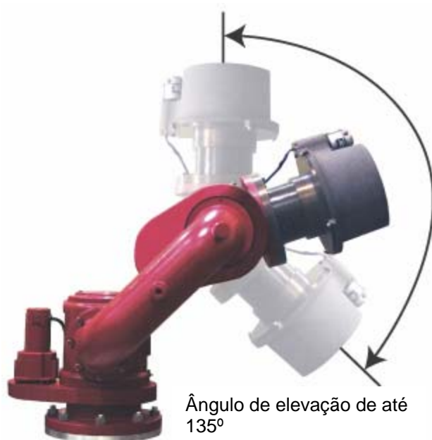
Fig. 5.41 - Conjunto de canhão monitor e Esguicho modelo Renegade, fabricado pela Akron Brass, equipado com dispositivo elétrico para movimento oscilatório vertical de até 135°, próprio para áreas industriais ou para montagem em viaturas. Tem vazão de até 19.000 lpm (5.000 gpm), com perda de carga de 190 kPa. Peso com todos acessórios de 70 Kg. Fonte: página eletrônica do fabricante
