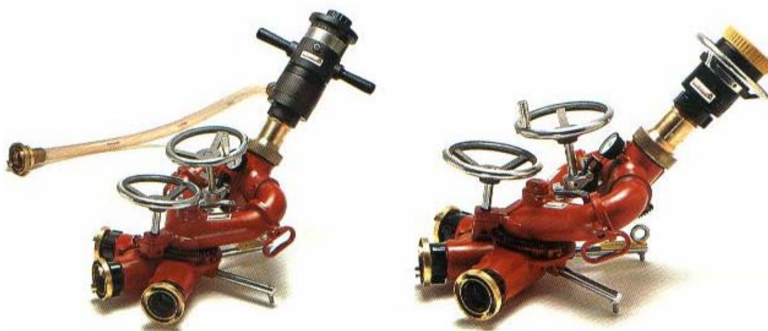
Fig. 5.39 - Modelo de canhão 8287 dotado de 3 introduções e equipados com esguicho LW-1000 para aplicação de espuma (o da esquerda, dotado de tubo pick-up) e com SM-100 (o da direita) para resfriamento. Notem-se os volantes para controle de giros horizontal e vertical e o manômetro.
