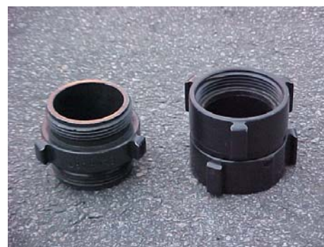
Figura 6.8. Suplementos de União macho à esq. e fêmea à dir.
