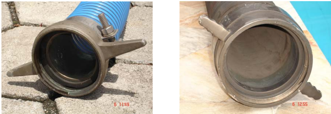
Fig. 4.3 - Detalhes das juntas de união fêmeas de mangotes de 115 mm (4½") e 150 mm (6") dotados de apoios para fácil pegada e de giro livre.
