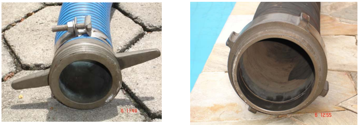
Fig. 4.4 - Detalhes dos engates machos de mangotes de 115 mm (4½") e 150 mm (6") dotados de apoios para fácil pegada.
