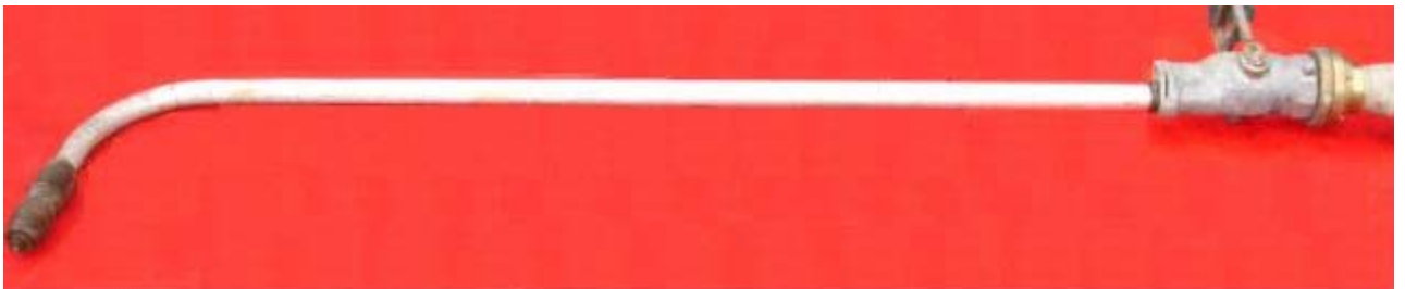
Fig. 5.30 - Tubo prolongador aplicador de neblina de baixa velocidade acoplado a esguicho universal.
